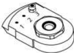
2. Konfiguration der Schleifmaschine für die Verwendung einer Schutz- oder Softauflage, Schraube und Mutter in Position 3 installiert.
