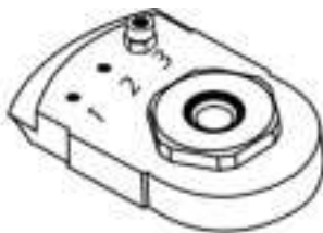
2. Konfiguracija uređaja za upotrebu pomoću štitnika ploča ili sučelja, vijak i matica postavljeni u položaj 3.
