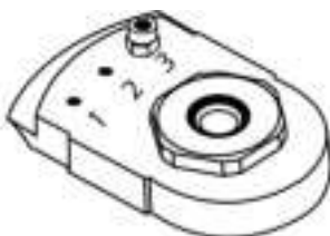
2. Конфигурация на машината за използване с предпазител за подложката или интерфейс, с винт и гайка, поставени на позиция 3.
